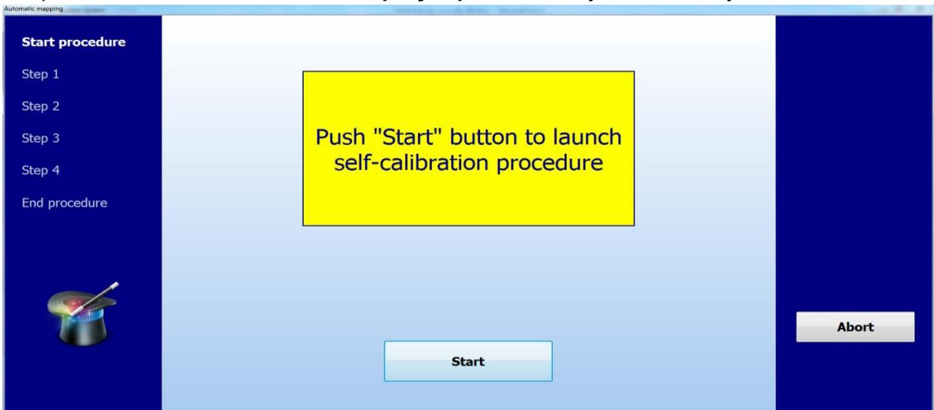
С помощью этого окна, нажав на кнопку “Старт“, можно начать процедуру “самокалибровки” автомобиля, во время которой программное обеспечение будет помогать потребителю шаг за шагом до полного ее завершения. Эта процедура может быть использована:
